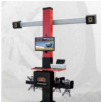
Alineadora marca MONDOLFO FERRO mod TRIGON Novo 3D con sistema lectura de 2 cámaras es rápido, preciso y fiable. El software es facil de usar para mediciones de alineación rápidas y precisas.
